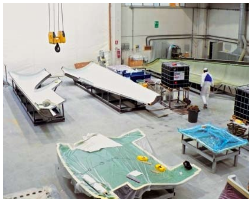
Assemblaggio di particolari in ACT Group, produttore di scafi in composito
